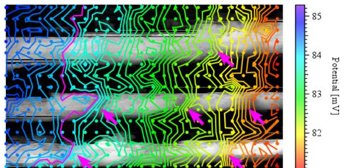
Fig.2 STM 形状像(グレースケール)と 電位分布(カラースケール)
